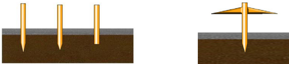
图 1 空间分离原理解解决打桩问题
